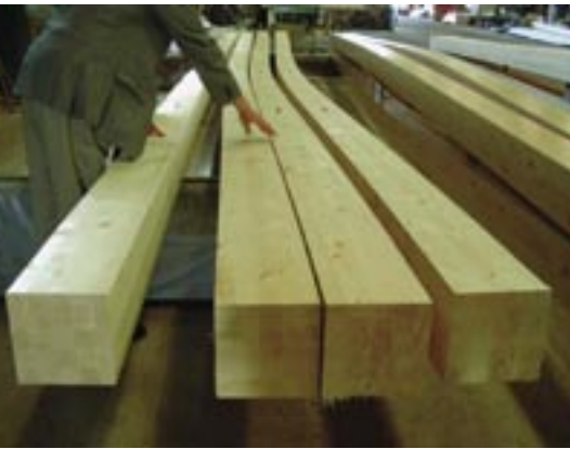
Kaareva liimapuuaihio sahattiin lamelleiksi ja taivutettiin toiseen suuntaan. Kahteen suuntaan kaarevat liimapuut liitettiin kimpupilariksi.
