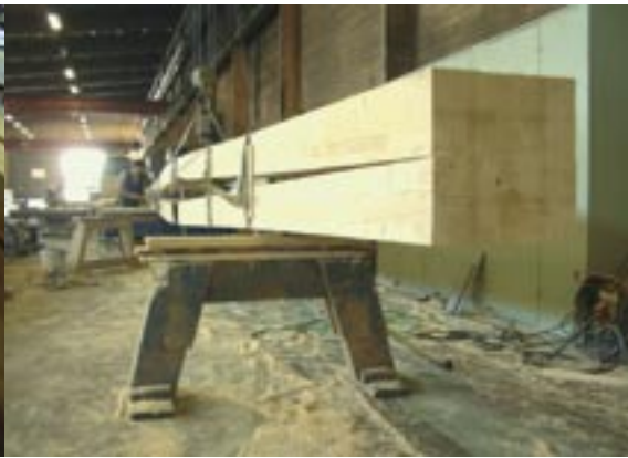
Kaareva liimapuuaihio sahattiin lamelleiksi ja taivutettiin toiseen suuntaan. Kahteen suuntaan kaarevat liimapuut liitettiin kimpupilariksi.
