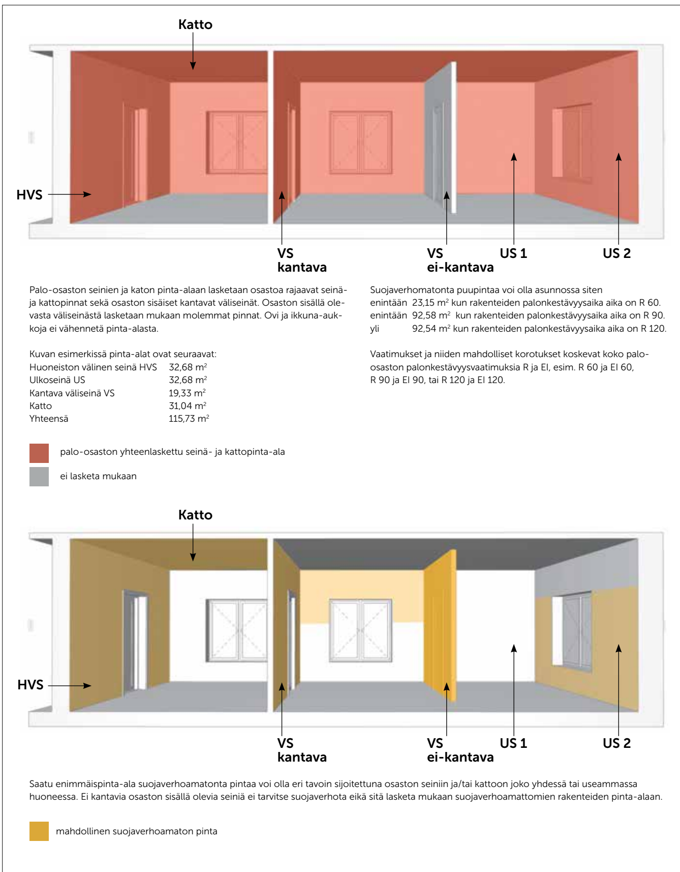
Kuva 21. Esimerkilaskelma puukerrostalon suojaverhouksen lievennyksistä.
